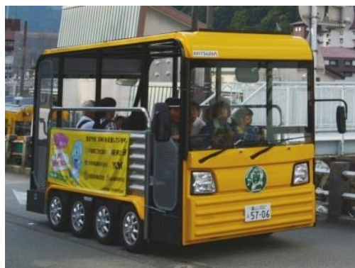
宇奈月温泉：低速電気バスEMU (提供：富山国際大学 上坂博亨教授)
